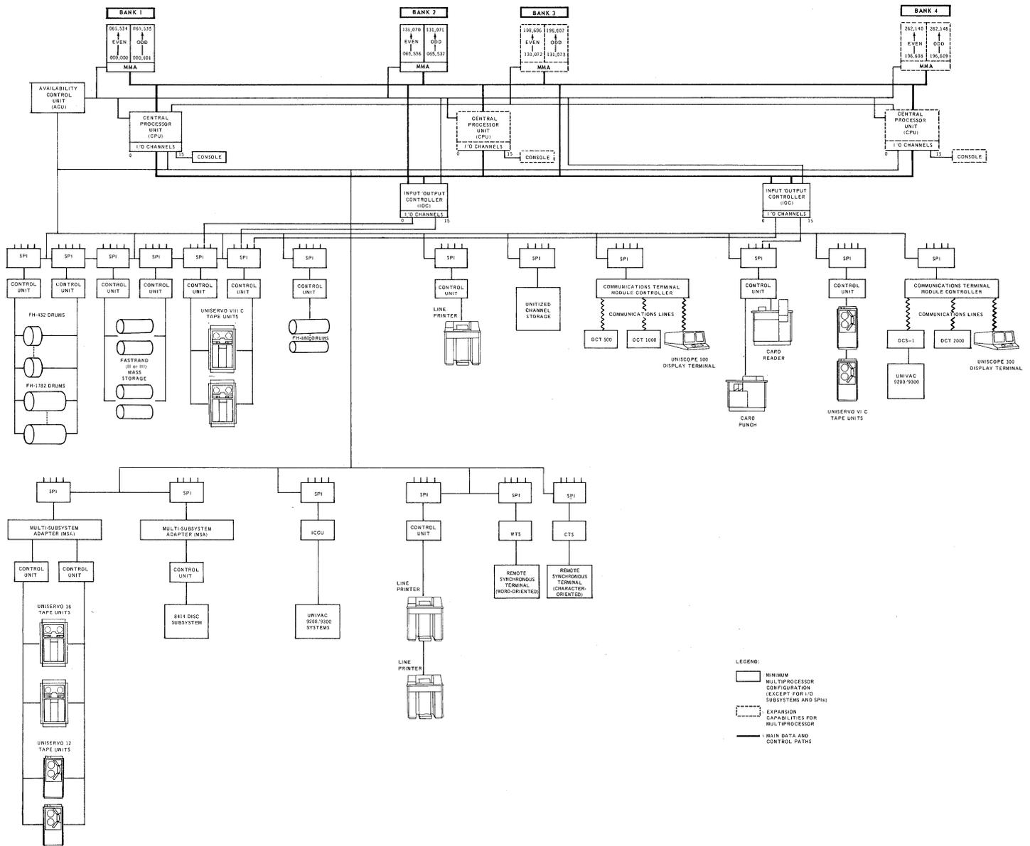
Figure 2-7. Multi-Processor System
