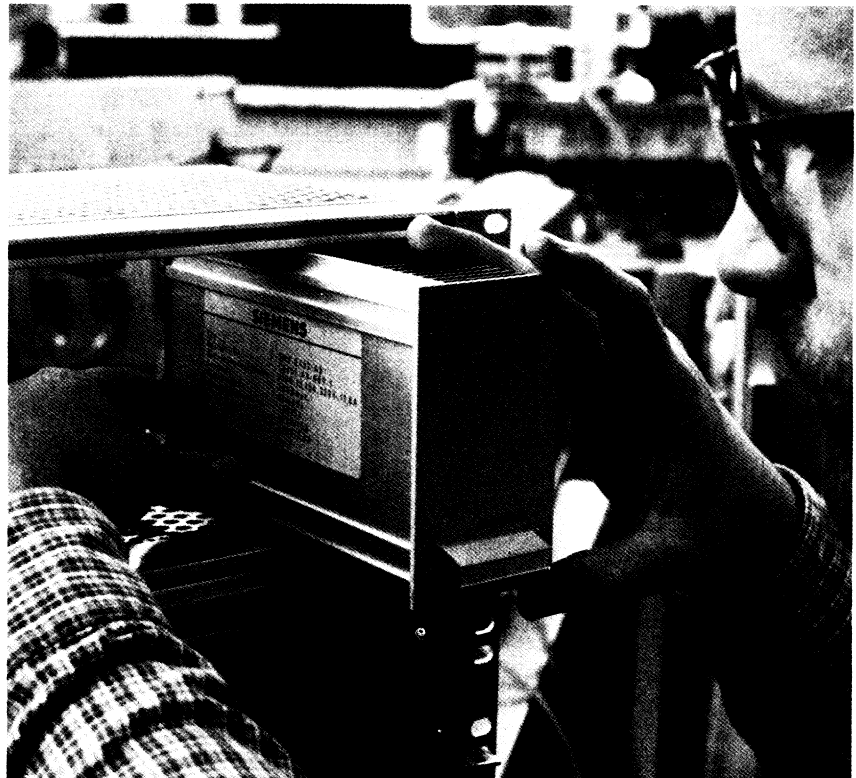
Das Netzgerät SMP-E432-A5 läßt sich platzsparend in Baugruppenträger integrieren
