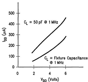
FIGURE 1-1.  $I_{DD}$  vs  $V_{DD}$
